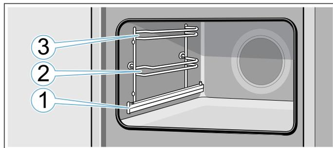
In den Einschubhöhen 2 und 3 das Zubehör immer zwischen die beiden Führungsstäbe einer Einschubhöhe schieben.
