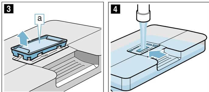
7. Abdeckung **a** wieder in die Öffnung am Wassertank einsetzen.
