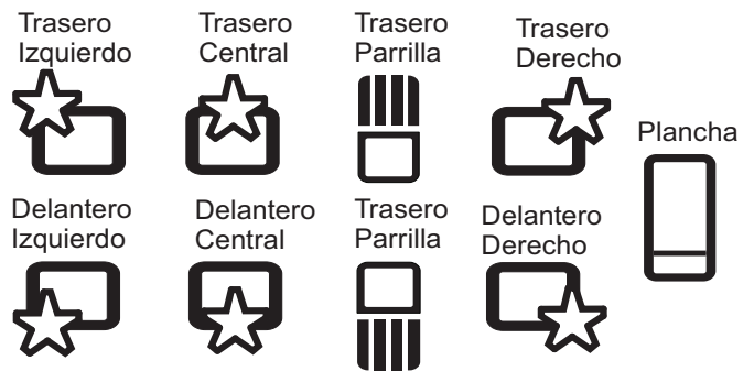
Figura 11: Símbolos de la superficie de la estufa
