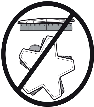
Figura 15: Tapa de quemador colocado incorrectamente
