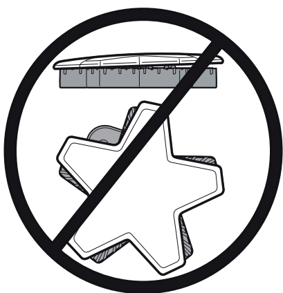
Figure 14 : Chapeau de brûleur incorrectement placé
