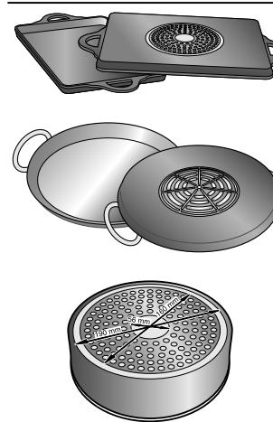
Kada se koriste velike posude s feromagnetičnom površinom manjeg promjera, zagrijava se samo feromagnetična površina, a time raspodjela topline može biti nejednolika.
