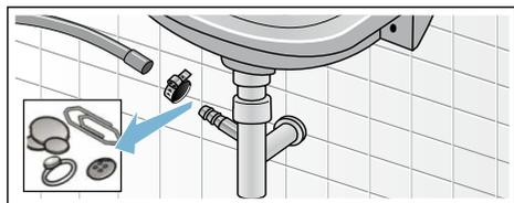
4. Collegare il tubo di scarico nel raccordo di scarico e serrare la fascetta stringitubo.
