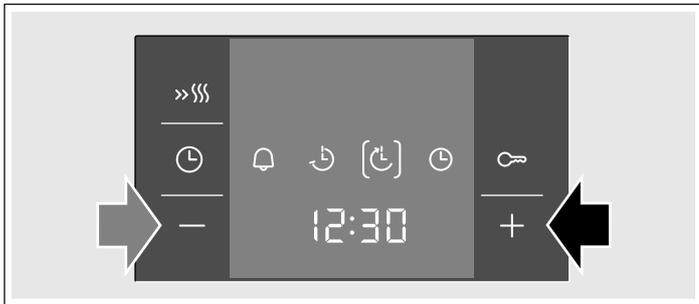
Pečica po nekaj sekundah prevzame nastavitve in se preklopi v način čakanja. Na prikazovalniku je prikazan čas konca
