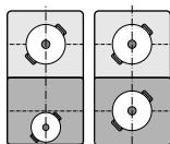
Etu- ja takaosaa, joissa kussakin on kaksi induktoria, voidaan käyttää täysin erillään toisistaan säättäen tarvittava tehotaso molempien alueisiin. On suositeltavaa käyttää ainoastaan yhtä keittoastiaa samanaikaisesti yhdellä alueella.
