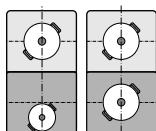
De främre och bakre zonerna, båda med induktorer, kan användas separat genom att man ställer in effekten för var och en. I det här fallet rekommenderas att man endast använder ett kokkärl per zon.
