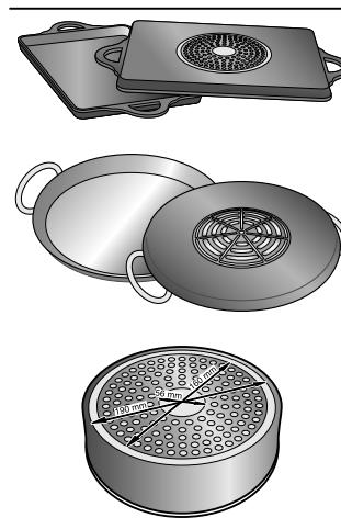
Kada se koriste velike posude s feromagnetičnom površinom manjeg promjera, zagrijava se samo feromagnetična površina, a time raspodjela topline može biti nejednolika.
