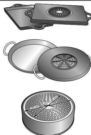
Då du använder stora kokkärl med en mindre ferromagnetisk diameter, värms endast det ferromagnetiska området, vilket innebär att värmefördelningen kanske inte blir jämn.
