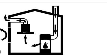
Les foyers à combustion alimentés en air ambiant (par exemple appareils de chauffage, au gaz, au bois, au fioul ou au charbon, les chauffe-eau, chauffe-eau accumulateurs) prélèvent l'air de combustion dans la pièce où ils sont installés et rejettent les gaz de fumée à l'extérieur par le biais d'un système spécifique (cheminée par exemple).
