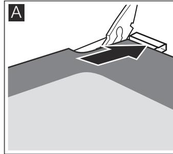
2. Die Abdeckung oben an der Backofentür aufsetzen und andrücken. Achten Sie darauf, dass die Kerben an den Seiten richtig einrasten.
