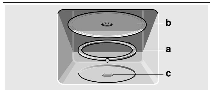
**Remarque :** Utilisez l'appareil uniquement avec le plateau tournant en place. Veuillez à ce qu'il soit correctement enclenché. Le plateau tournant peut tourner à gauche ou à droite.
