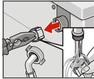
Sieb mit Zange herausnehmen und reinigen.
