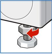
1. Kontermutter mit Schraubenschlüssel im Uhrzeigersinn lösen.
