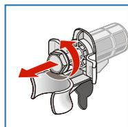
3. Alle 4 Transportsicherungsschrauben lösen und entfernen.
