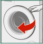
1. Einfüllfenster öffnen und Wäsche entnehmen.
