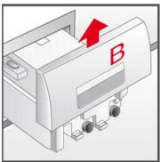
3. Zum Entleeren der Dosierbehälter jeweiligen Verschlussstopfen vorsichtig abziehen und Inhalt in ein geeignetes Gefäß ablassen.
