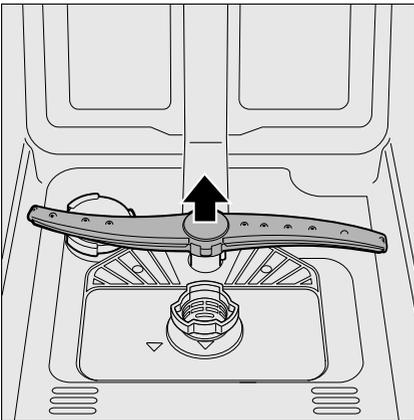
4. Sprüharme unter fließendem Wasser reinigen.
