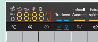
kg, 7,0\*: Empfohlene maximale Beladung in kg für das ausgewählte Wasch-/Trocknungsprogramm. → Seite 7, **Programmübersicht**
