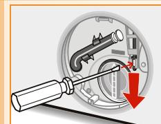
Programm wird fortgesetzt, wenn der Strom wieder fließt. Muss die Wäsche entnommen werden, kann das Einfüllfenster wie folgt geöffnet werden:
