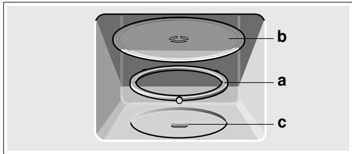
**Aanwijzing:** Gebruik het toestel alleen met draaischijf. Zorg ervoor dat hij goed ingeklikt is. De draaischijf kan naar links of rechts draaien.
