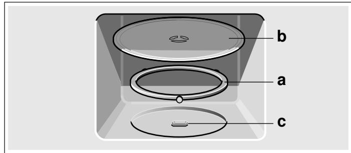
**Hinweis.** Benutzen Sie das Gerät nur mit eingesetztem Drehsteller. Achten Sie darauf, dass er richtig eingerastet ist. Der Drehsteller kann sich links oder rechts herum drehen.
