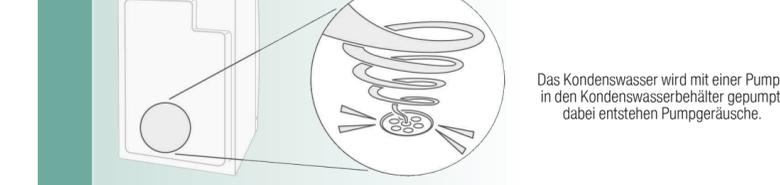
Das Kondenswasser wird mit einer Pumpe in den Kondenswasserbehälter gepumpt, dabei entstehen Pumpengeräusche.
