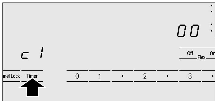
3. Pulse **Timer** (Temporizador) repetidamente hasta que aparezca la indicación visual de la función deseada en el display del elemento.
