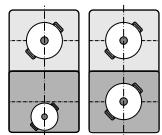
Las zonas de cocción delantera y trasera, con dos inductores cada una, se pueden utilizar de forma independiente. La posición de cocción se ajusta individualmente para cada zona de cocción. Utilizar un solo recipiente para cada zona de cocción.
