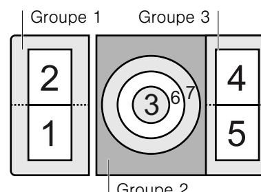
**Remarque :** Pour obtenir la puissance maximale sur la zone de cuisson flexible, placez l'ustensile de cuisson au milieu de la zone de cuisson, tel que décrit au chapitre Zone de cuisson flexible.
