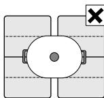
En placas de cocción con dos zonas de cocción flexibles, no utilizar nunca las dos zonas de cocción a la vez para un solo recipiente.
