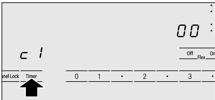
3. Touchez **Timer** (Minuterie) à répétition jusqu'à ce que l'indicateur de la fonction souhaitée apparaisse sur l'écran de l'élément.
