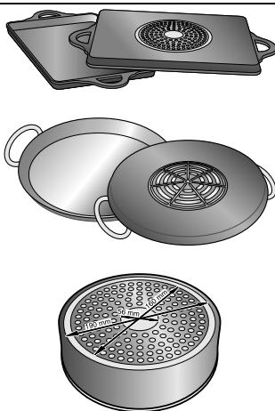
Si la base del recipiente no es completamente ferromagnética, solo se calentará la superficie magnetizable y eso podría provocar que el calor no se distribuya de forma homogénea.
