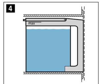
7. Gerätetür schließen. Der Wassertank ist gefüllt. Sie können den Betrieb starten.
