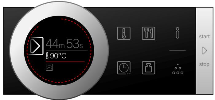
Wenn die Dauer beendet ist, ertönt ein Signal. Das Gerät hört auf zu heizen. Im Display steht die Dauer 00m 00s.
