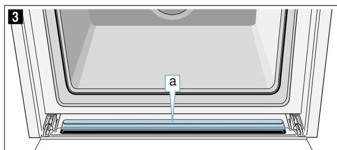
**Remarque :** Si le joint s'est détaché, démontez la porte de l'appareil et remplacez le joint sur la gouttière. → "Porte de l'appareil" à la page 34
