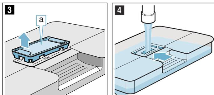
7. Remettre le cache **a** en place dans l'ouverture du réservoir d'eau.
