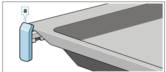
Les rails télescopiques s'encliquettent lorsqu'ils sont entièrement retirés. Il est ainsi facile de poser l'accessoire dessus. Pour le déverrouillage, repousser les rails dans le compartiment de cuisson avec une légère pression.
