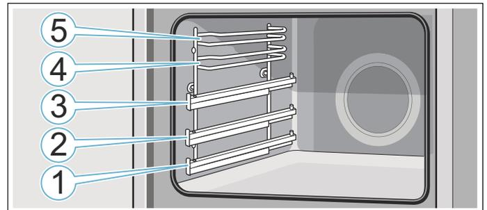
Aux niveaux d'enfournement 4 et 5, introduire l'accessoire toujours entre les deux barres de guidage d'un niveau d'enfournement.
