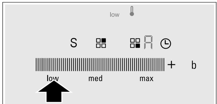
Stegefunktionen er aktiveret. Temperatursymbolet **↓** forbliver tændt, indtil stegetemperaturen opnås. Derefter høres et lydsignal, og temperatursymbolet slukkes.
