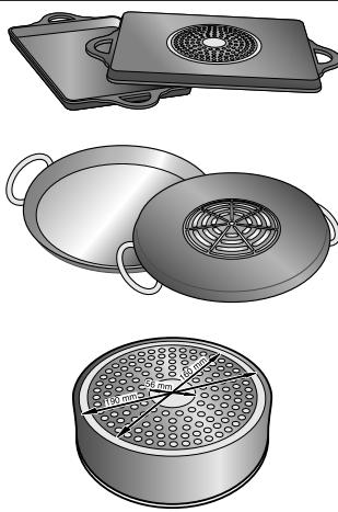
Se utilizar recipientes grandes com uma área ferromagnética de diâmetro mais pequeno, apenas a zona ferromagnética vai aquecer, pelo que a distribuição de calor pode não ser homogénea.
