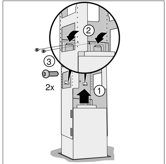
3. Sicherungsbügel einhängen und festschrauben.
