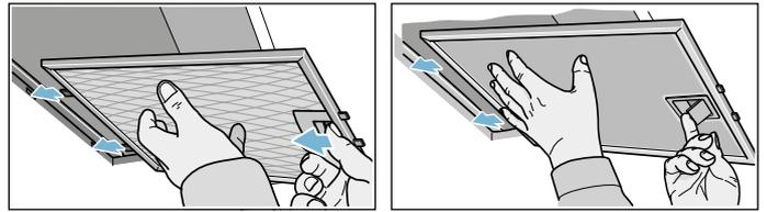
Bei Randabsaugungsfiltern, den Metallfettfilter nach unten ziehen. Dabei mit der anderen Hand unter den Metallfettfilter fassen.
