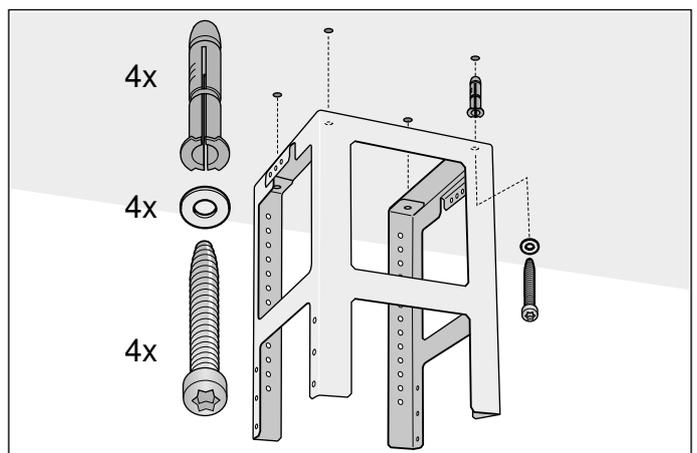
4. Vier Löcher mit Ø 8 mm und Bohrtiefe 80 mm für die Befestigungen bohren und die Dübel bündig eindrücken
