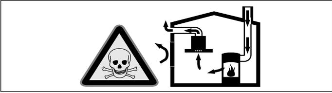
Raumluftabhängige Feuerstätten (z.B. gas-, öl-, holz- oder kohlebetriebene Heizgeräte, Durchlauferhitzer, Warmwasserbereiter) beziehen Verbrennungsluft aus dem Aufstellraum und führen die Abgase durch eine Abgasanlage (z.B. Kamin) ins Freie.
