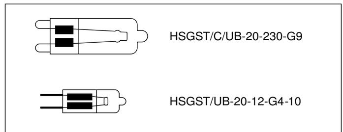
**Hinweis:** Halogenlampen dürfen beim Einsetzen nicht am Glasbolben berührt werden. Zum Einsetzen der Halogenlampen ein sauberes Tuch verwenden.
