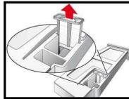
3. Filter unter fließendem Wasserstrahl oder in der Geschirrspülmaschine reinigen.
