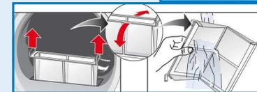
5. Beide Teile unter fließendem Wasser durchspülen und gut abtrocknen.
