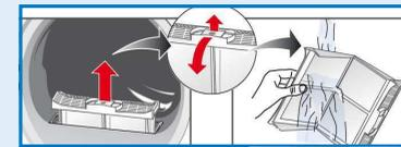
2. Beide Teile des Flusensiebes herausziehen.
