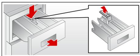
3. Lavare la vaschetta detersivo e l'inserto con acqua, spazzolarli e asciugarli. Pulire anche l'interno dell'alloggiamento.
