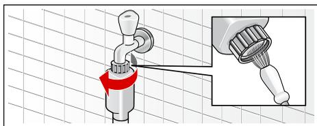
6. Nei modelli Standard e Aqua-Secure pulire il filtro nella parte posteriore dell'apparecchio: svitare il raccordo di carico dell'acqua dal lato posteriore dell'apparecchio. Estrarre il filtro con la pinza e lavarlo.
