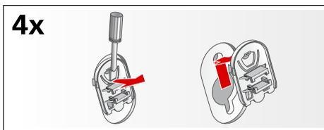
2. Inserire tutti i 4 blocchi. Fissare il cavo di alimentazione nei fermi. Inserire e stringere le viti.
