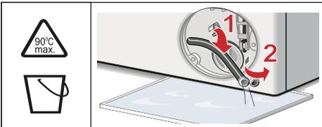
5. Svitare con cautela il coperchio della pompa, l'acqua residua può fuoriuscire. Pulire l'interno, la filettatura del coperchio della pompa e il corpo della pompa. Deve essere possibile ruotare il girante della pompa di scarico. Applicare di nuovo il coperchio della pompa e serrarlo a fondo. L'impugnatura deve essere in posizione verticale.
