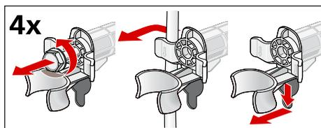
3. Applicare le coperture. Bloccarle saldamente premendo sul gancio di fermo.
