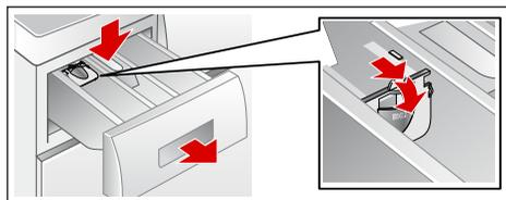
**Avvertenza:** Non utilizzare il dosatore per detersivo tipo gel, detersivo in polvere e per programmi con prelavaggio oppure con funzione Fine fra selezionata.
