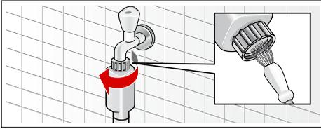
6. Bei Modellen Standard und Aqua-Secure Sieb an der Geräterückseite reinigen:
