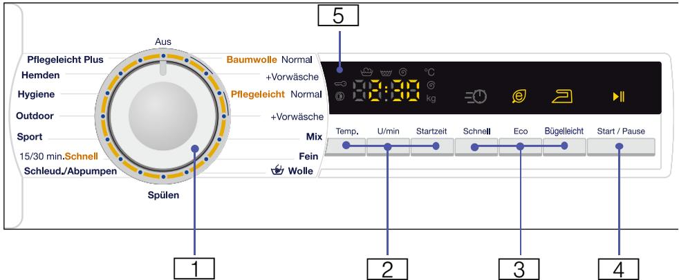
**1** Programmwähler zum Wählen eines Programms und Ein/Aus-Schalter
