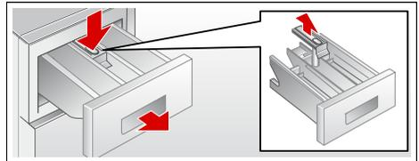
3. Einspülschale und Einsatz mit Wasser und Bürste reinigen und abtrocknen. Auch Gehäuse innen reinigen.
