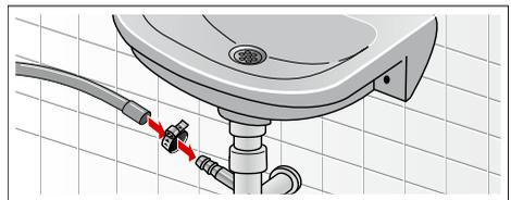
■ **Ablauf in ein Kunststoffrohr mit Gummimuffe oder einen Gully**
