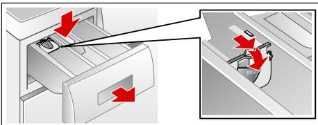
**Hinweis:** Verwenden Sie die Dosierhilfe nicht bei gelartigen Waschmitteln und Waschpulver und bei Programmen mit Vorwäsche bzw. gewählter Fertig in-Zeit.
