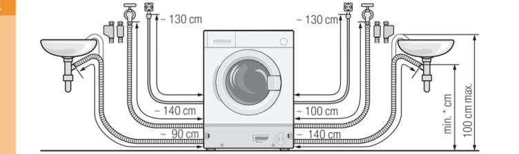
Remarque : l'utilisation des fixations de flexible réduit la longueur de flexible ! Disponible auprès des revendeurs spécialisés/du service après-vente - Rallonge pour flexible d'arrivée d'eau froide ou Aqua-Stop (env. 2,50 m). Réf. WMZ2380, WZ10130, CZ11350, Z7070X0
