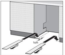
Humidifiez les plaques de guidage avec de l'eau mélangée à du produit vaisselle avant d'encaster le lave-linge. N'utilisez pas de graisse ni d'huile !
