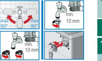
2. Ouvrez le robinet d'eau avec précaution et vérifiez l'étanchéité des points de raccordement. Attention : au niveau du raccord, l'eau est sous pression.
