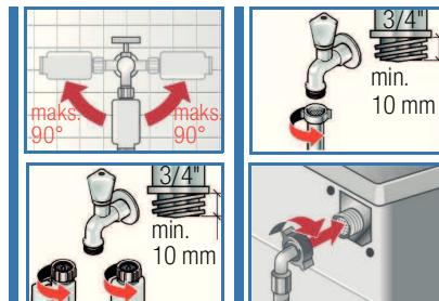
1. Koble vanntilførselsslangen til vannkranen.
