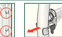
2. Løsne og ta ut alle de fire transportsikringsskruene.
