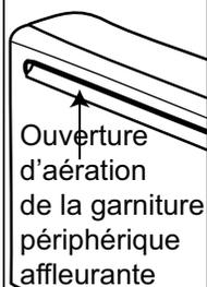
**NE bloquez et n'obstruez PAS** les prises d'air de ventilation. L'ouverture d'aération du four est située à l'arrière de l'appareil. Les ouvertures d'aération ne doivent pas être obstruées. Elles doivent être ouvertes pour permettre la circulation d'air nécessaire au fonctionnement adéquat du four.
