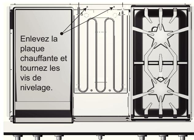
Figure 26 : Vis de nivelage de la plaque chauffante
