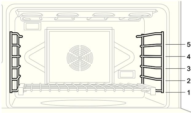
Figure 1 : Positions des grilles dans le grand four
