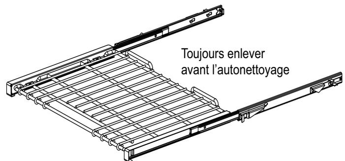
Figure 28 : Position des grilles du four
