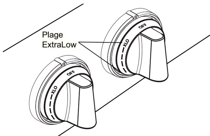
Figure 14 : Bouton de contrôle de brûleur ExtraLow
