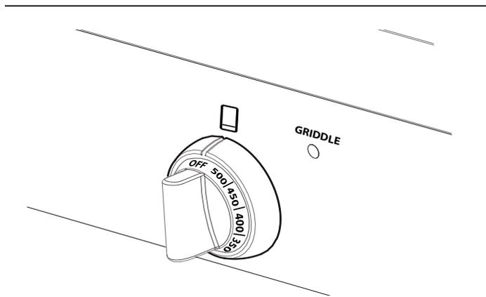
Figure 25 : Bouton de commande de la plaque chauffante
