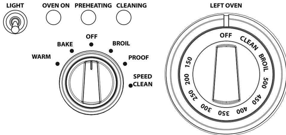
Figure 32: Réglage du four auxiliaire (modèle de 48 po)
