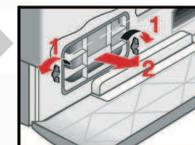
5. Luftkühler entfernen.
