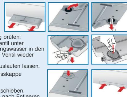
Ventil im Kondenswasserbehälter auf Verunreinigung prüfen: Sollten sich Flusen am Ventil abgesetzt haben → Ventil unter fließendem Wasser abspülen. Zusätzlich etwas Leitungswasser in den leeren Kondenswasserbehälter füllen und durch das Ventil wieder entleeren. Ventil dazu eindrücken und Wasser vollständig herauslaufen lassen.
