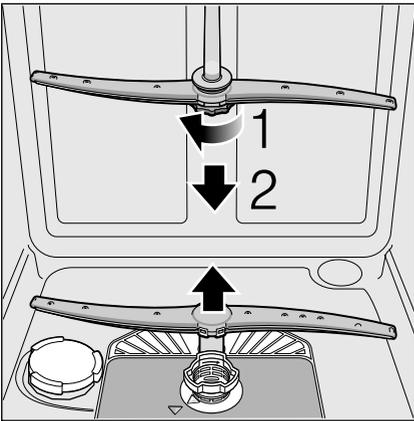
4. Sprüharme unter fließendem Wasser reinigen.
