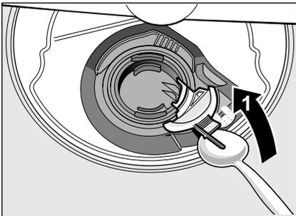
6. Flügelrad auf Fremdkörper prüfen und diese gegebenenfalls entfernen.
