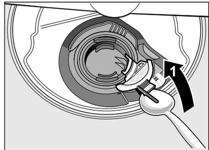
6. Preverite krilno kolo, če so med krilca zašli tujki in jih po potrebi odstranite.
