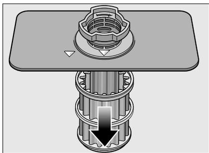
3. Morebitne ostanke odstranite, sita pa očistite pod curkom tekoče vode.
