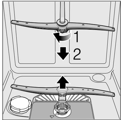
4. Sprüharme unter fließendem Wasser reinigen.
