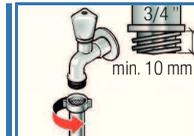
2. Den Wasserhahn sorgfältig drehen und prüfen, dass die Verbindungspunkte nicht lecken. **Achtung:** Die Schraubverbindung steht unter dem Druck der Wasserleitung.
