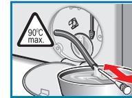
4. Pumpendeckel sorgfältig abschrauben (Vorsicht: Restwasser). Das Innere, Pumpendeckelgewinde und Pumpengehäuse reinigen (Flügelrad in der Pumpe muss sich drehen lassen).
