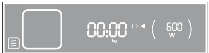
2. Usar el mando giratorio para programar la potencia del microondas.
