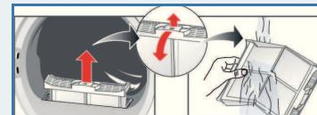
3. Odstranite vlakna in oba filtra za vlakna izperite pod tekočo vodo ter ju dobro posušite.
