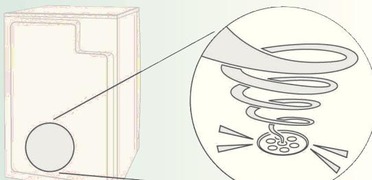
Kondenzacijsko vodo črpalka črpa v posodo za kondenzacijsko vodo, pri čemer nastajajo zvoki črpanja.
