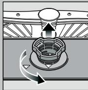
Kierrä siiviläylinteriä, irrota siiviläjärjestelmä ...
