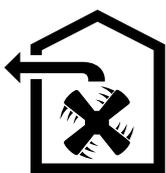
De aangezogen lucht wordt door de vetfilters gereinigd en via een buizensysteem naar de buitenlucht afgevoerd.
