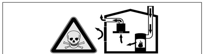
I focolari che dipendono dall'aria ambiente (peres. a gas, olio, legna o carbone, scaldabagno, caldaie elettriche) ricavano l'aria per la combustione dalla stanza ed eliminano i gas di scarico all'esterno attraverso un impianto (peres. camino).
