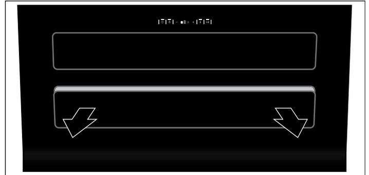
3. Lüftungsblende in der Halterung nach rechts schieben und abnehmen.
