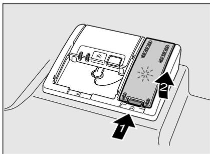
2. Llenar el abrillantador cuidadosamente hasta alcanzar la marca de máximo llenado del depósito.
