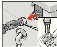
Sieb mit Zange herausnehmen und reinigen.
