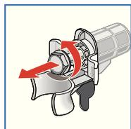
3. Alle 4 Transportsicherungsschrauben lösen und entfernen.
