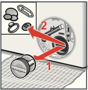
5. Pumpendeckel vorsichtig abschrauben und Innenraum, Gewinde des Pumpendeckels und Pumpengehäuse reinigen (Flügelrad der Laugenpumpe muss sich drehen lassen.)
