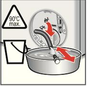
4. Entleerungsschlauch aus der Halterung nehmen.
