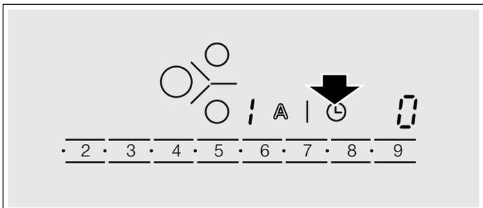
En la pantalla izquierda parpadean de forma alterna c y 1, y en la derecha se muestra 0.
