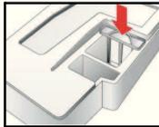
5. Kondenswasserbehälter einschieben bis zum Einrasten.
