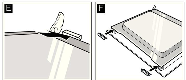
7. Abdeckung aufsetzen und anschrauben.
