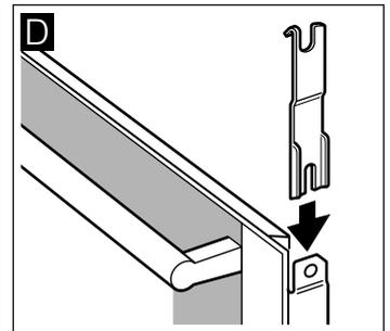
6. Abdeckung aufsetzen und anschrauben. Lässt sich die Abdeckung nicht anschrauben, prüfen ob die Scheiben richtig in der Halterung sitzen.
