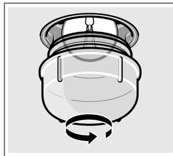
3. Lampe durch den gleichen Lampentyp ersetzen.
