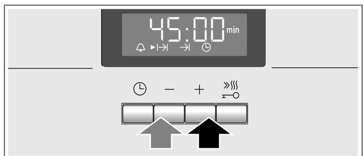
Nach wenigen Sekunden startet der Backofen. In der Anzeige läuft die Dauer sichtbar ab und das Symbol
