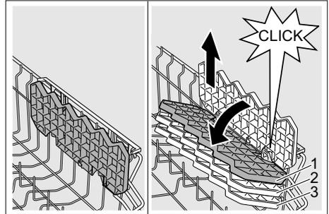
\* Je nach Modell ist eine 3-fache Höhenverstellung möglich. Dafür die Etagere zuerst senkrecht stellen und nach oben ziehen, dann, leicht schräg gestellt, nach unten auf die gewünschte Höhe (1, 2, oder 3) schieben und mit einem hörbaren Klick einrasten lassen.
