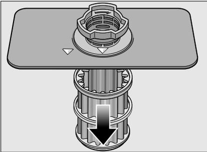
3. Eventuelle Reste entfernen und Siebe unter fließendem Wasser reinigen.
