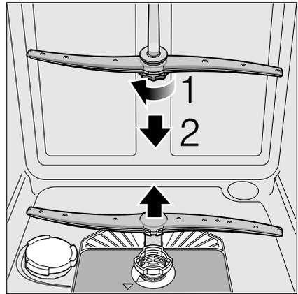
4. Sprüharme unter fließendem Wasser reinigen.
