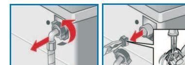
2. Schlauch anschließen und auf Dichtheit prüfen.
